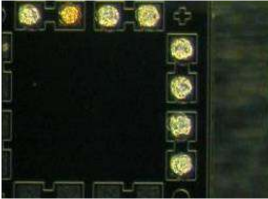
Figure 16. TEG Die after Die Shear
